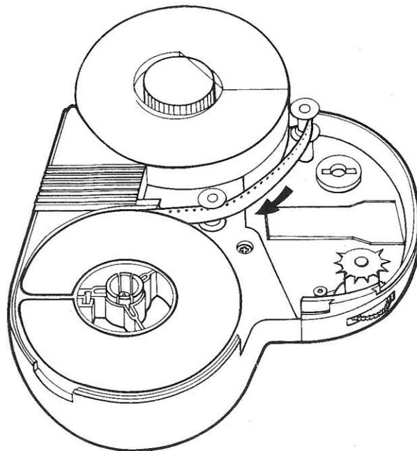
Zur Reinigung der Filmfuehrungsbahn Adaptor Deckel 15 entfernen durch Drehen des Verschlussknopfes 14 mit einer Muenze.
