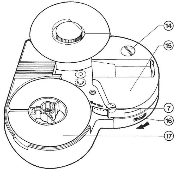
Rueckspulen: Filmende durch Drehen des Rades 16 im Uhrzeigersinn aus der Oeffnung 7 herausfuehren und direkt – nicht ueber Filmfuehrungs Rolle 10 – im Zentrum der leeren Spule befestigen.
