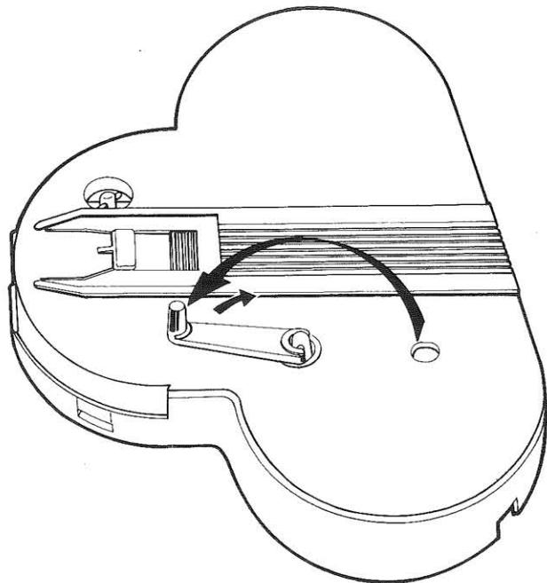
Rueckspularm 13 herausklappen – wie abgebildet – und im Uhrzeigersinn drehen.
