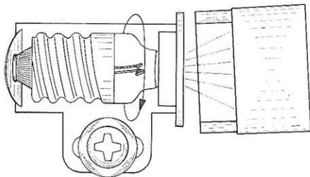
El TELE-CASSETTE PACTRA, viene provisto de una lámpara OSRAM 3643 2,5 Volt. - 0,2 Amp.
