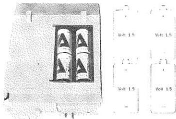
Coloca 4 pilas de 1,5 volt., tipo R 20, situadas tal como indica la figura.
