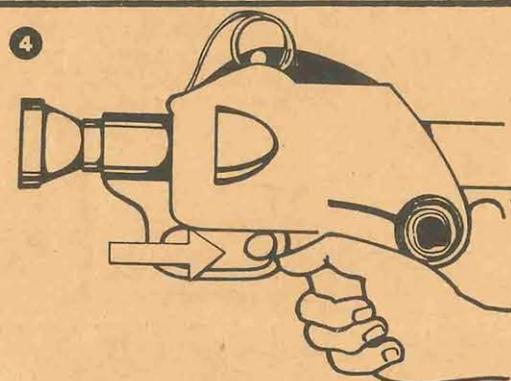
4 Bei jedem weiteren, langsamen Durchschalten des Filmtransporthebels erscheint nun ein weiteres Bild, welches möglichst auf eine weiße Fläche (Wand, Decke usw.) projiziert werden kann.
