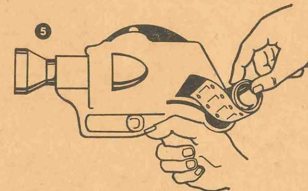
7 Am Ende der Vorführung Filmtransporthebel so lange durchziehen, bis Film aus dem Magazin herausgenommen werden kann.
