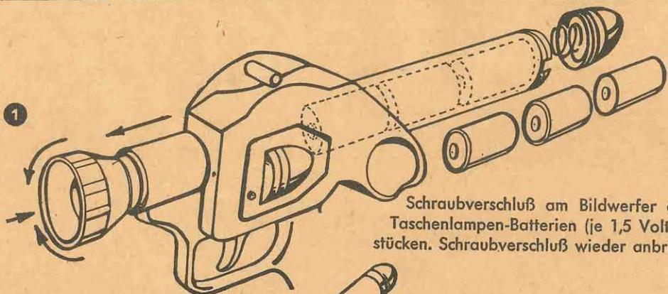
1 Schraubverschluss am Bildwerfer abnehmen und mit 3 neuen Taschenlampen-Batterien (je 1,5 Volt — Plus-Pol nach vorne!) bestücken. Schraubverschluss wieder anbringen.
