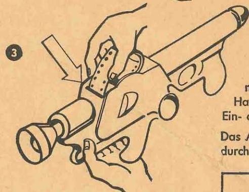
3 Filmanfang in Einführschlitz bringen und Film bis zum Anschlag nach unten schieben.
