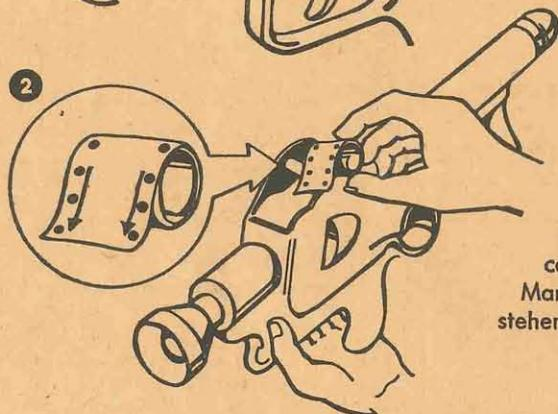
2 Filmrolle über den Spulzapfen ziehen. Darauf achten, daß der ca. 10 cm leere Filmanfang freiliegt und eingeführt werden kann. Man beachte, daß der Filmstreifen auf alle Fälle auf dem Kopf stehend und seitenverkehrt (Spiegelschrift) eingeführt wird.
