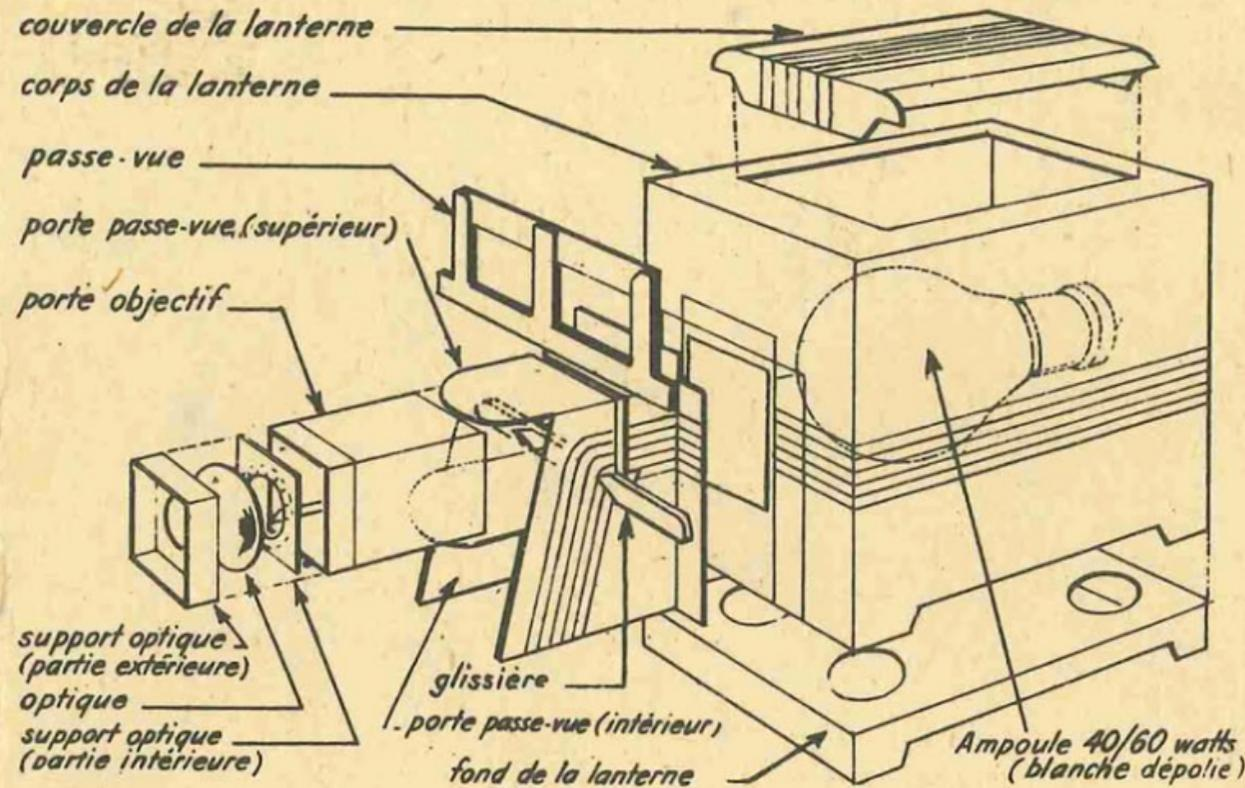
**SUPPORT OPTIQUE.** Prendre (la partie intérieure); retirer le rond central; repousser légèrement les petites pattes; encoller cette pièce en sa totalité sur le côté blanc; placer l'optique proprement dite, bien centrée.
