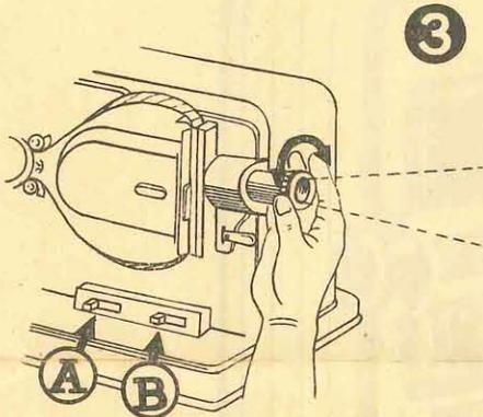
4) Bildstrichverstellung durch Auf- und Abziehen des Stellhebels
