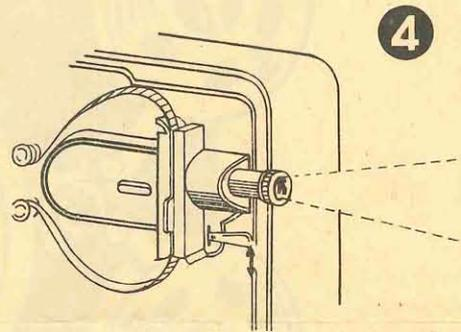
5) Zum Lampenwechsel wird nach Entriegeln das Lampenhaus geöffnet und die Halterung herausgeschwenkt
