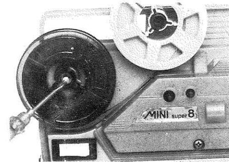
6. Falls Aufwickelspule nicht mitläuft, mit Schraubenzieher wie Abbildung Schraube nach rechts etwas nachziehen.
