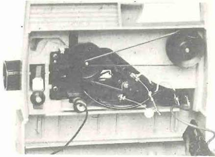
9. Zum Riemenwechsel bei Beschädigungen hintere Deckelschraube lösen. Es werden somit alle mechanischen Teile des Projektors freigelegt. Aus dem Bild ist die genaue Lage der Überführungen und der elektrischen Leitungen ersichtlich.
