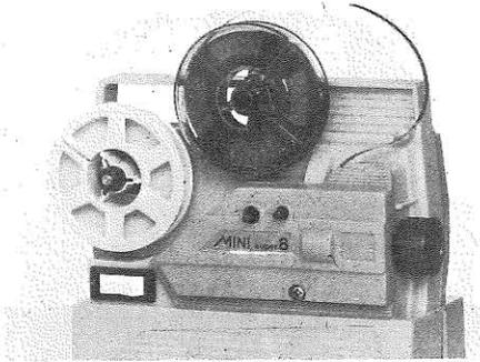
2. Die volle Filmspule wird auf den oberen, die Leerspule auf den unteren Zapfen aufgeschoben.
