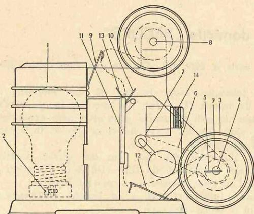
Der Apparat wird normal mit einer Haushaltlampe 60 Watt in 220 Volt geliefert. Falls andere Voltstärken gewünscht werden, bitten wir dies bei Bestellung anzugeben.
