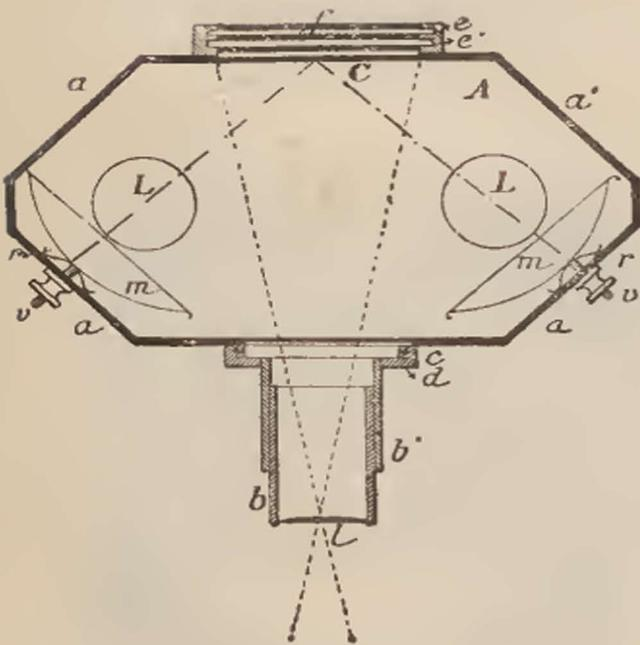
Coupe de l'Appareil disposé pour la projection des objets opaques.
