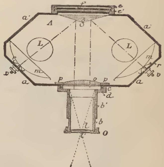
Coupe de l'Appareil disposé pour la projection des objets transparents photographiés sur verre, bandes ordinaires de lanterne magique, tableaux mécanisés.
