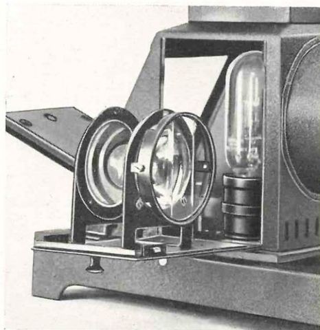
Abb. 9: Veranschaulichung der Zugängigkeit zur Lampe durch herausklappbaren Kondensorteil (Hohlspiegel, eine Kondensorlinse, Wärmeschutzscheibe)
